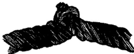
Рисунок 15. Перекручивание каната.
