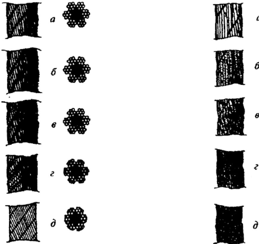
Рисунок 5. Износ наружных проволок каната крестовой свивки:
