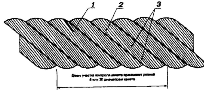
Рисунок 4. Определение числа обрывов наружных проволок стального каната:
