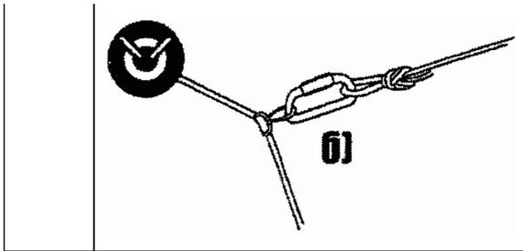
нагрузки каната, так как исключена возможность проскальзывания оттяжки вдоль каната. Это необходимо учитывать при установке оттяжек, стараясь располагать их по биссектрисе угла между направлениями приложения нагрузок на опорный канат.
