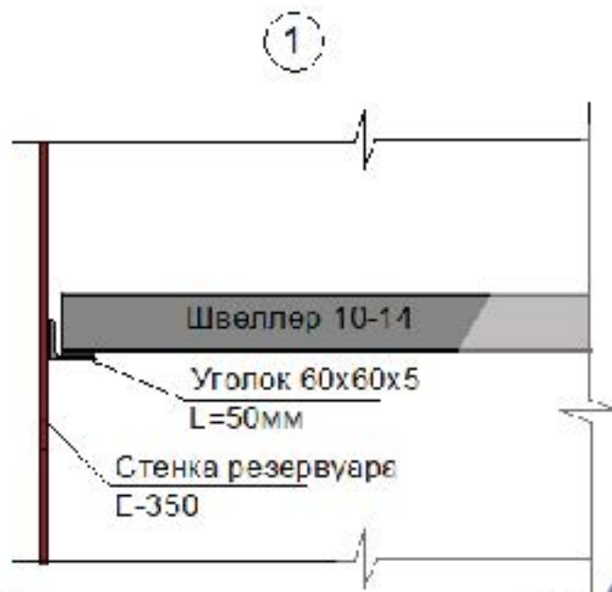
Рис. Схема усиления жесткости стенок резервуара Е-350.
