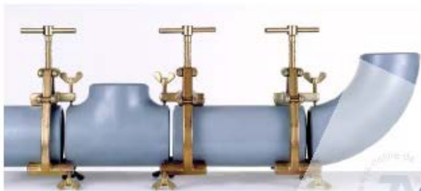
Рис. 3. Наружный центратор для сборки труб с отводами и тройниками
