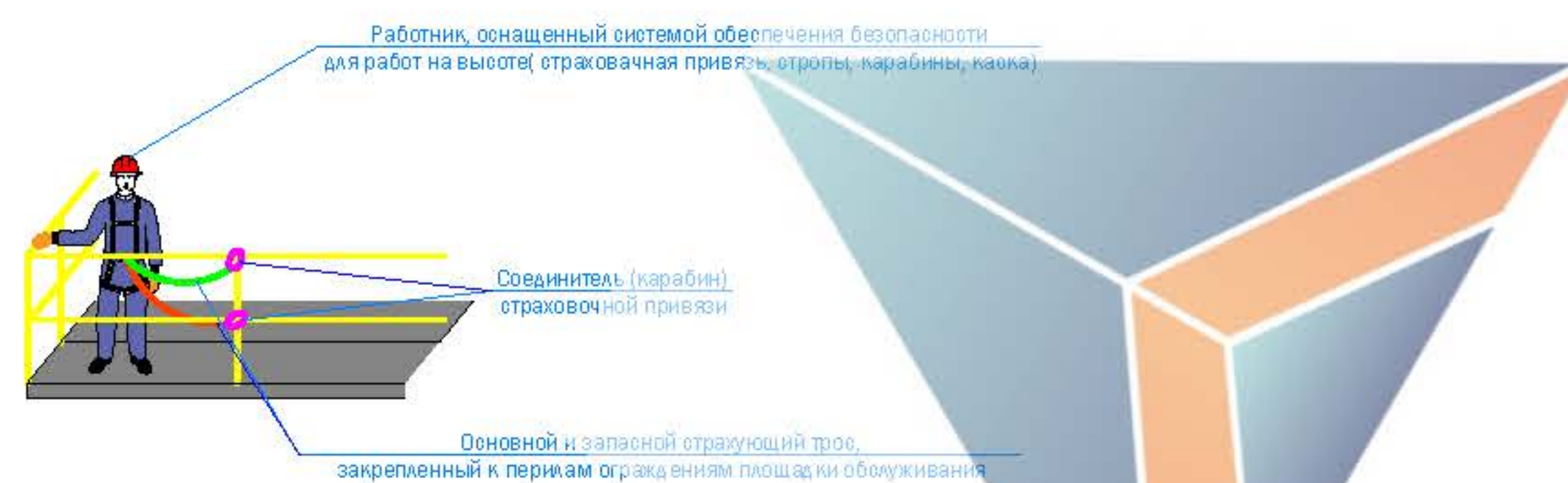
Способ крепления систем безопасности на площадке обслуживания
